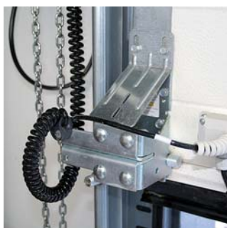
Bodenkonsole mit Seilbruchsicherung
