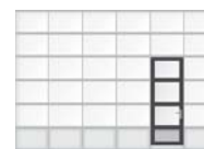
Bodensektion mit Alu-Stucco-Füllung und Schlupftür
