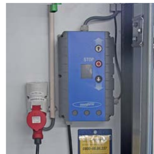
Serienmäßige Steuereinheit (Schaltkasten)
