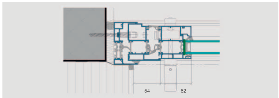
Horizontalschnitt mit Bedienungsflügel, einwärts öffnend
