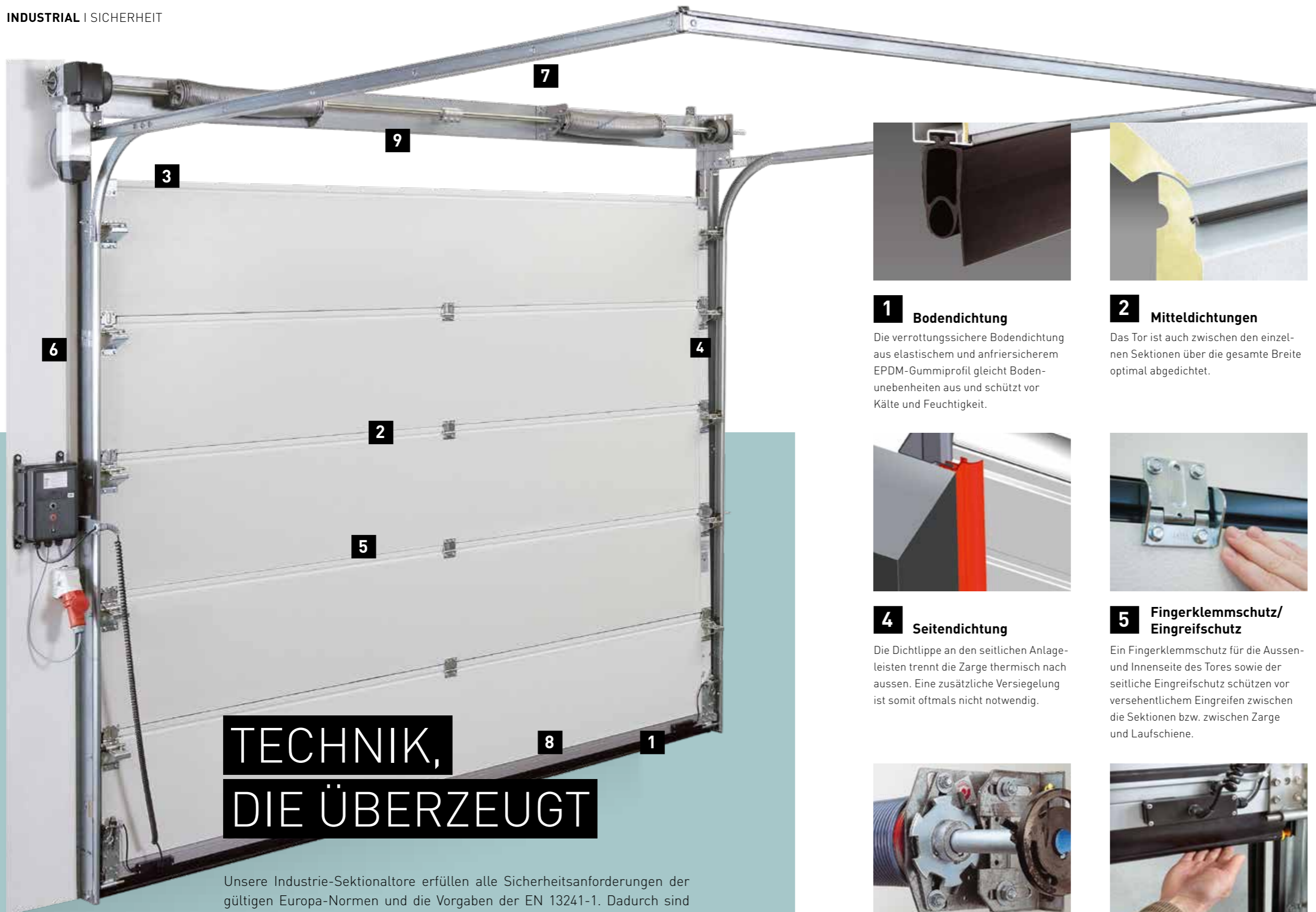
7 Federbruchsicherung für handbetätigte Tore Stoppt bei Bruch der Torsionsfeder die Drehung der Welle. Das Tor wird in seiner Position gehalten. Ein Abstürzen des Tores wird somit sicher verhindert.
