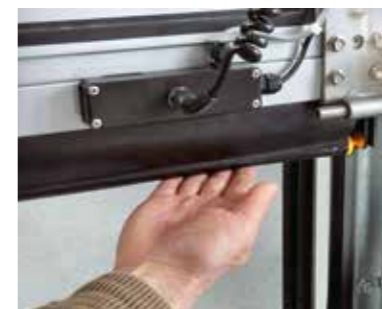
8 Schliesskantensicherung Elektrisch betätigte Tore mit Impulssteuerung erhalten werkseitig eine vormontierte Schliesskantensicherung, die das Tor entsprechend der ASR A1.7 beim Treffen auf ein Hindernis nicht nur stoppt, sondern dieses durch Reversieren auch direkt wieder freigibt.
