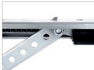
Schiene mit Erweiterungsset Zusätzliche, mechanische Absicherung gegen unbefugtes Aufschieben des Tores. Die Klinke rastet dabei in der Schiene ein und verhindert so das Öffnen.
