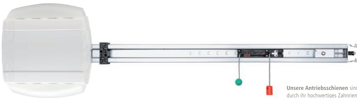
Notentriegelung Bei einem Stromausfall kann das Tor über die Notentriegelung sicher geöffnet und wieder geschlossen werden. Durch Ziehen der Entriegelung wird das Tor vom Antrieb getrennt. Das Tor kann manuell bedient werden.
