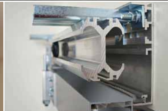
stabile Laufschiene mit kugelgelagerten Laufwagen, langlebig und sehr leise im Torlauf - Sturzprofil mit Laufschiene
